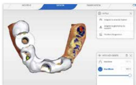
Puis il réalise le design du guide qui est imprimé au cabinet à l'aide d'une imprimante 3D SLA PrimePrint (Dentsply Sirona).
