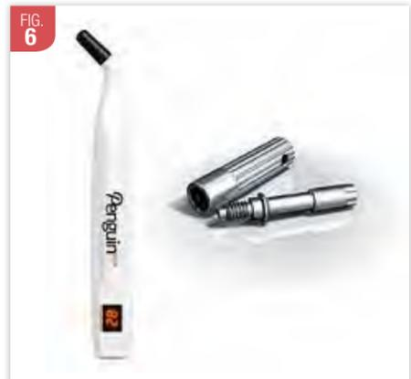
Le Penguin RFA à gauche avec son Multipeg et le Driver à droite. Source : Sennerby, Resonance frequency analysis for implant stability measurements. A review, 2015.
