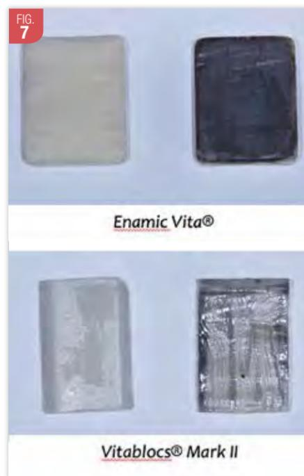
Chaque échantillon a été soumis à une force abrasive par brossage électrique. Le test consiste à immerger les échantillons dans de l'eau à température ambiante puis d'appliquer une tête de brosse à dents en action sur les surfaces de biomatériaux maquillés. La brosse à dents utilisée est l'Oral B Vitality Braun®. Les échantillons sont immergés dans une solution eau + dentifrice.
