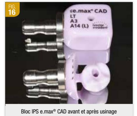
À la fin de l'usinage, il est nécessaire de venir retirer l'ergo permettant le lien entre la couronne et la base du bloc. Pour cela, une fraise diamantée à grain fin est utilisée. La couronne est ensuite positionnée sur un support réfractaire (IPS e.max® CAD Crystallization Tray, Ivoclar) avec sa tige de cristallisation (IPS e.max® CAD Crystallization Pin XS) au centre du four. La couronne est stabilisée par la pâte de cuisson réfractaire (IPS Object Fix Putty).
