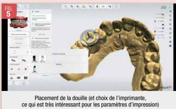
FIG. 5 Placement de la douille (et choix de l'imprimante, ce qui est très intéressant pour les paramètres d'impression)
