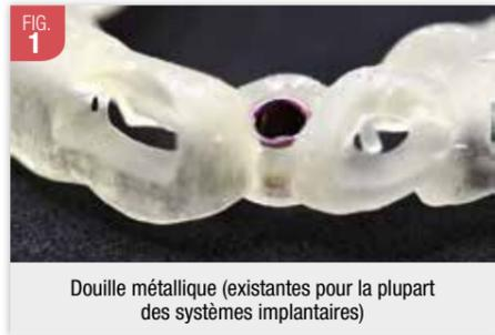
commencer. Il s'agit de la planification implantaire. Une fois celle-ci réalisée, il faudra déterminer les douilles à utiliser, réaliser leur placement et modéliser le guide (les douilles étant les petites parties métalliques à travers lesquelles les forets devront passer pour être guidés).
