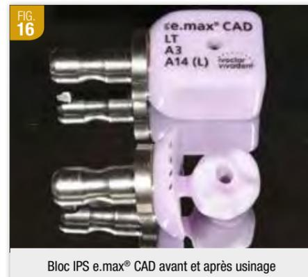
À la fin de l'usinage, il est nécessaire de venir retirer l'ergo permettant le lien entre la couronne et la base du bloc. Pour cela, une fraise diamantée à grain fin est utilisée. La couronne est ensuite positionnée sur un support réfractaire (IPS e.max® CAD Crystallization Tray, Ivoclar) avec sa tige de cristallisation (IPS e.max® CAD Crystallization Pin XS) au centre du four. La couronne est stabilisée par la pâte de cuisson réfractaire (IPS Object Fix Putty).
