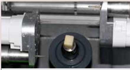
a. Machine-outil à commande numérique équipée de 2 jeux de fraises de diamètres et de granulométrie distincts
