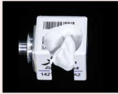
FIG. 10 Couronne antérieure en zircone multicouche usinée à sec à l'aide de fraises en carbure de tungstène
